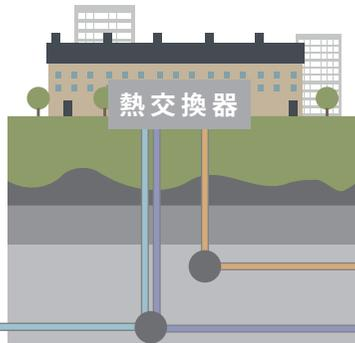
中川ポンプ場に熱交換器を設置し、安定的に発生する下水の熱利用を行う。回収した熱は地域冷暖房に送られる。
