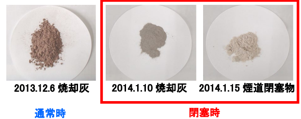
図3 閉塞物の外観
