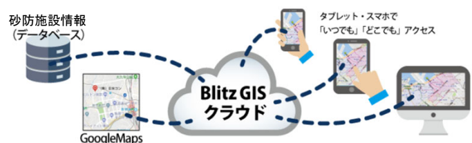
図2 クラウド型砂防維持管理システムBlitz GISの概要図
