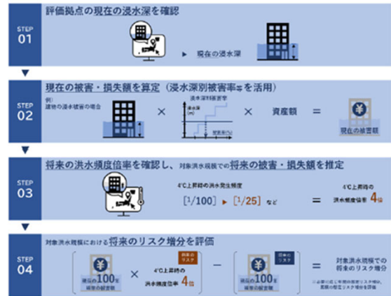
図2 国交省手引きによる洪水リスク評価の流れ
