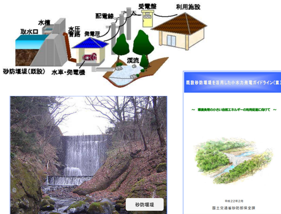
図4 砂防施設を活用した小水力発電事例(砂防堰堤落差方式)
