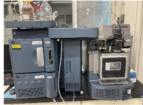
図3 液体クロマトグラフ質量分析計
